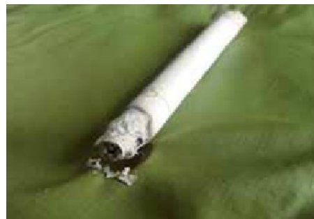
Zkoušky hořlavosti zahrnovaly přiložení malého zdroje plamene na materiál spacáku a také zkoušku hořící cigaretou.
