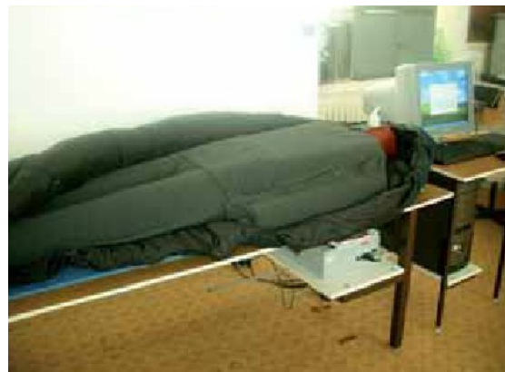
Měřicí figurína pro zkoušení teplotních charakteristik spacáků.
